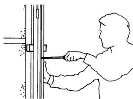
Efter justering skall dörren vara lätt att öppna och stänga. Sedan kan skruvas fast låssidan på samma sätt som på gångjärnssidan.
