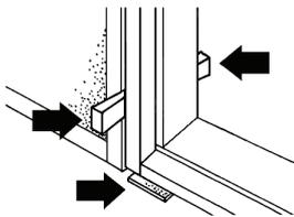
5. Kontrollera med vattenpass att karmsidor står i lod och att hörnen är vinkelräta.
